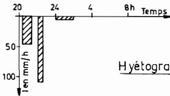
Hyetogramme au pluviomètre enregistreur S1
