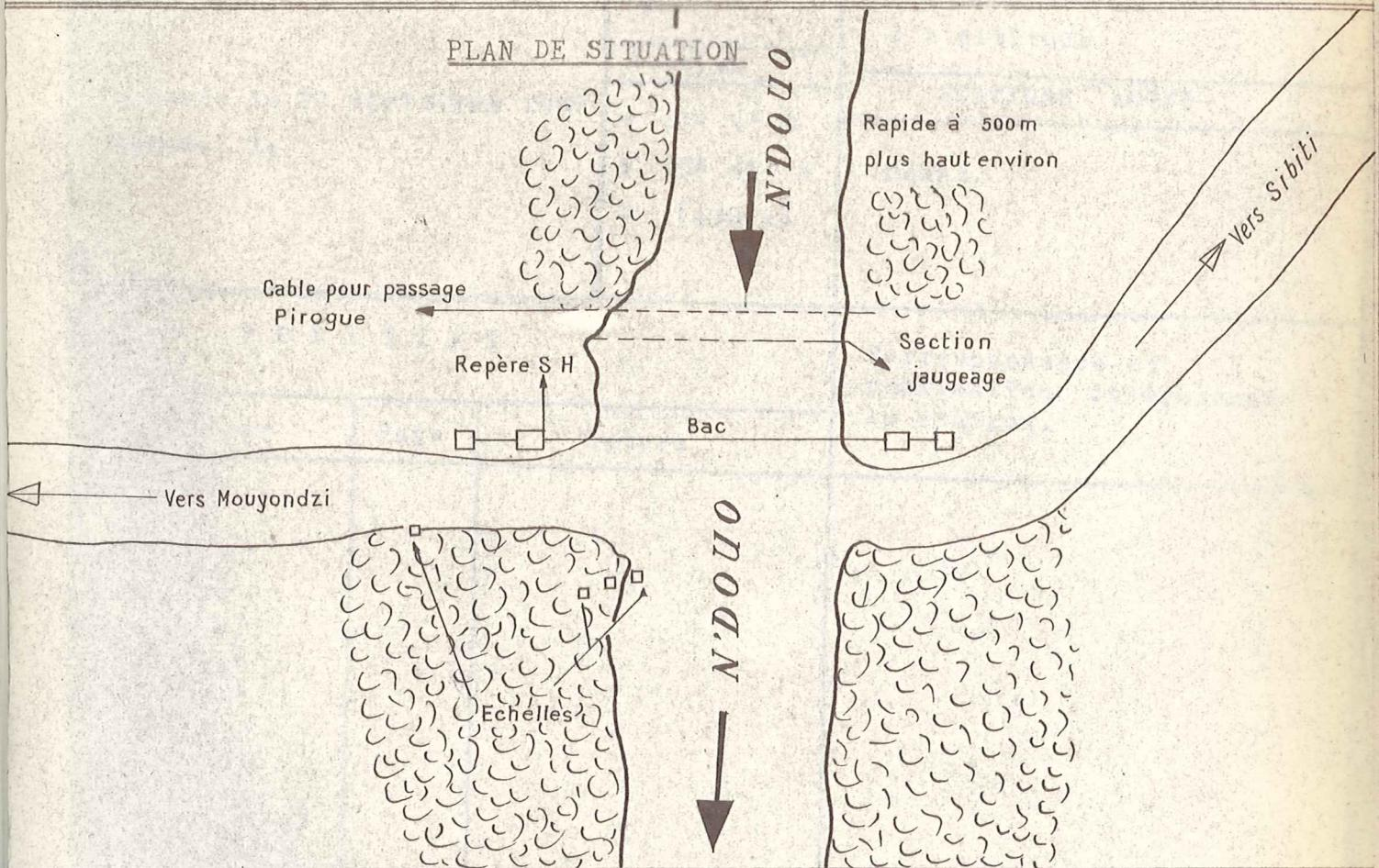
NIVELLEMENT DU 0 DE L'ECHELLE
