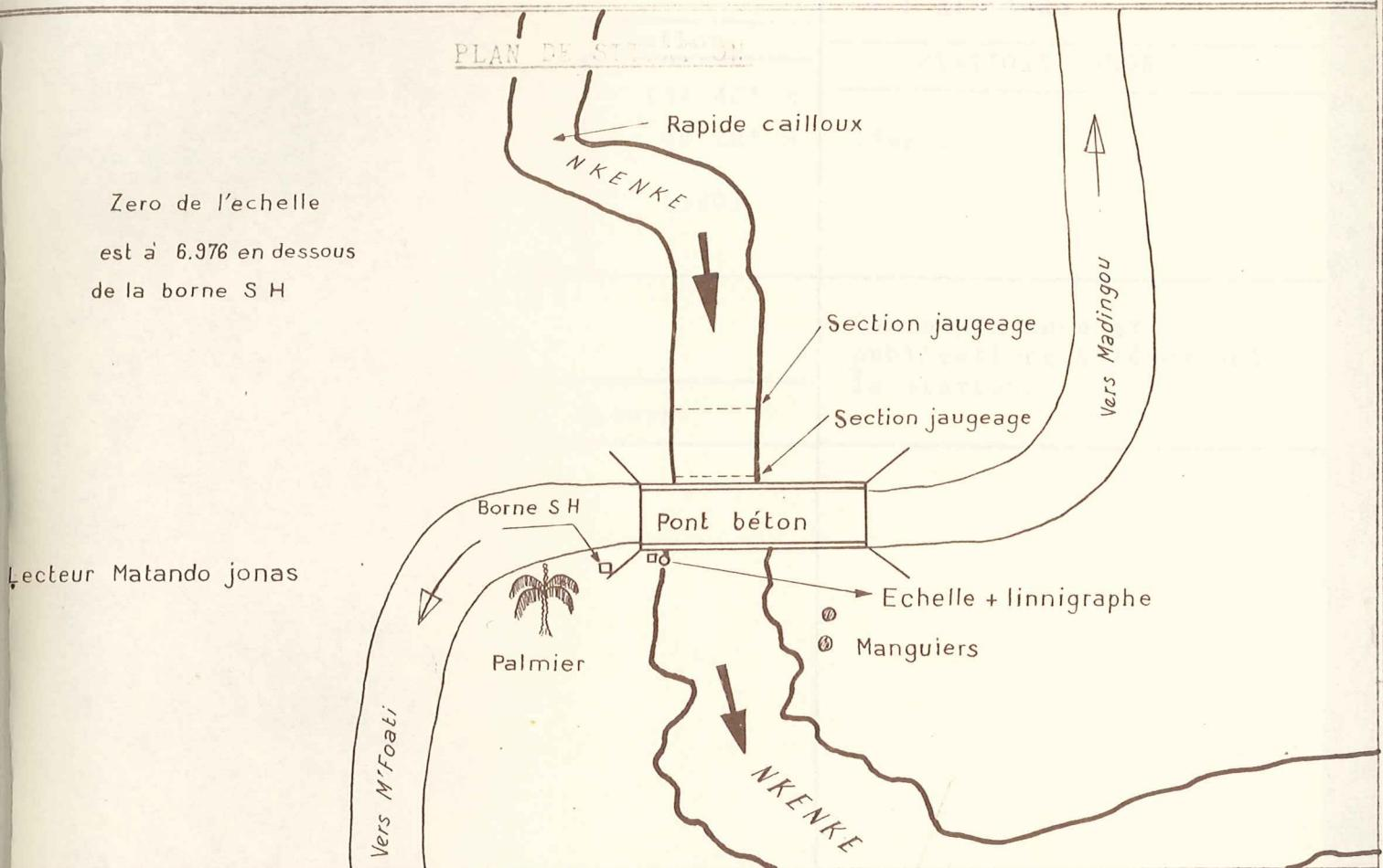
NIVELLEMENT DU 0 DE L'ECHELLE
