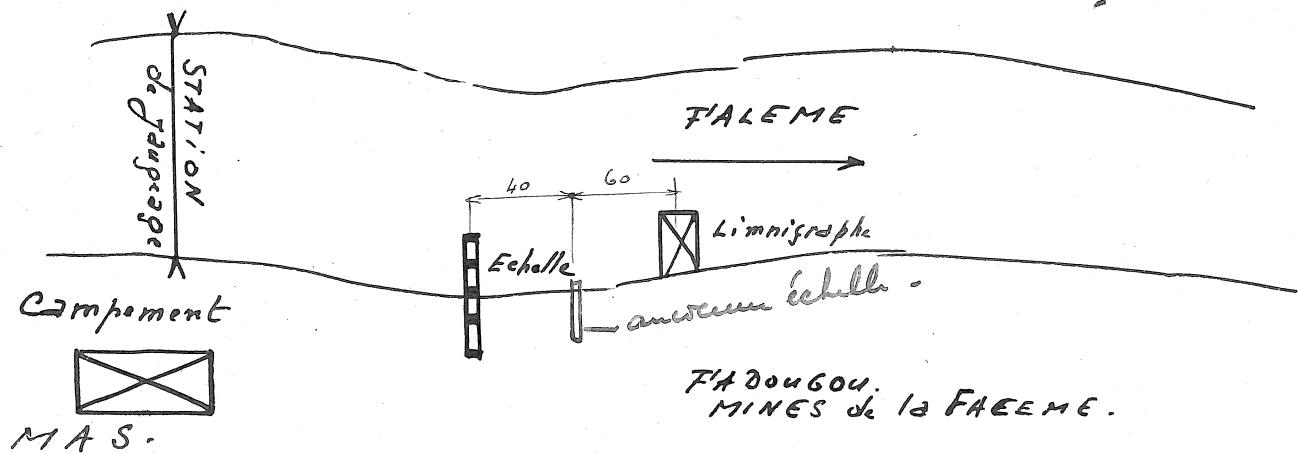
Composition de la station. 1 Echelle d'ivue en 1/2re enrouillée de 0 à 10 mètres
