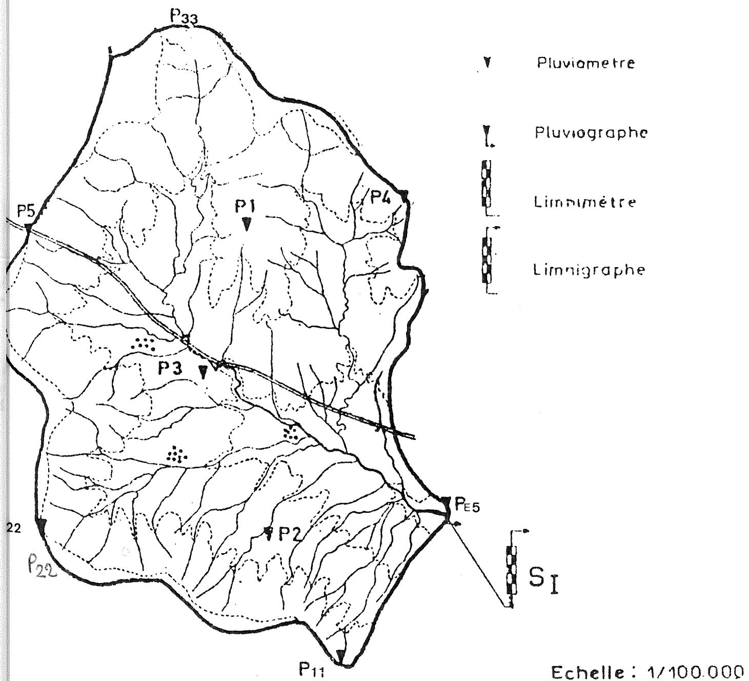
Fig. 7. Situation des appareils de mesures (Bassin d'Ibohamane).
